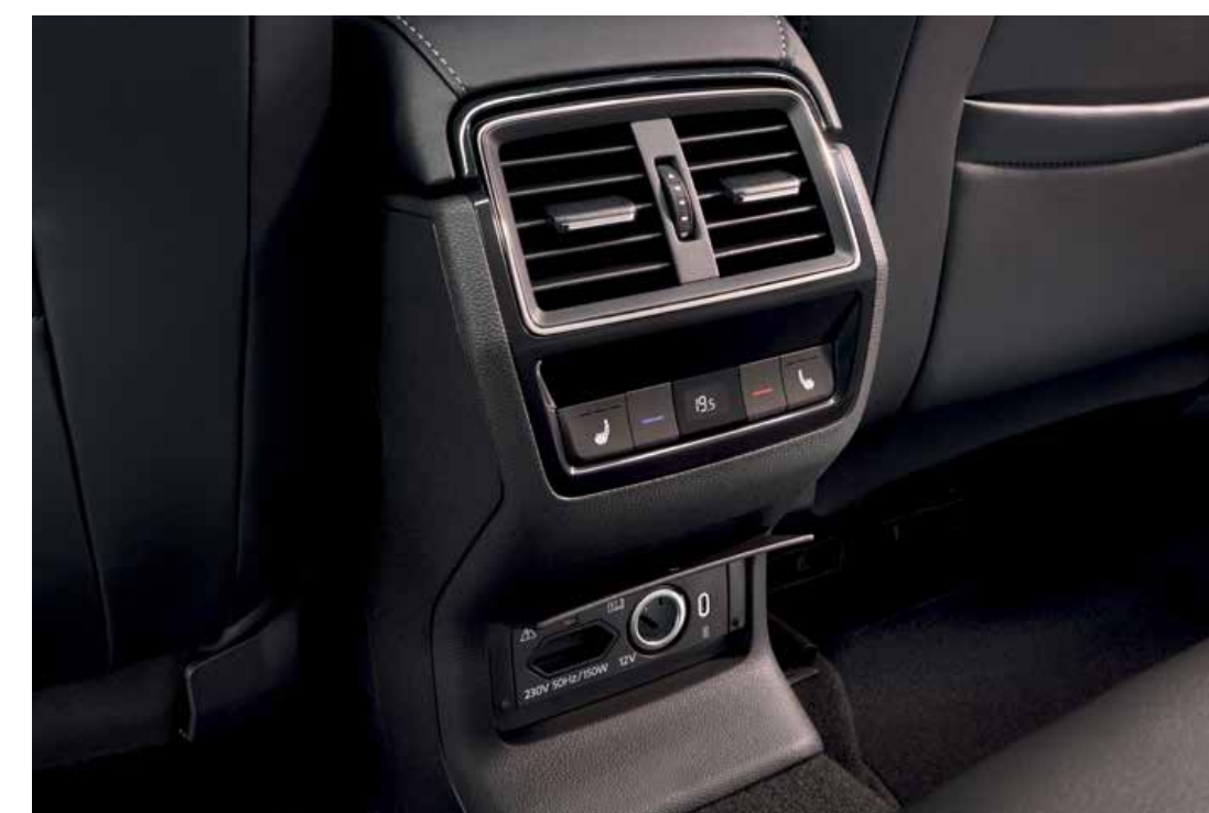
230V zásuvka a nabíjecí USB-C port pro cestující vzadu
