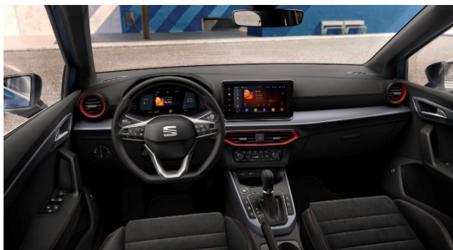
Digitální přístrojový štít s 10,25" barevným TFT displejem
